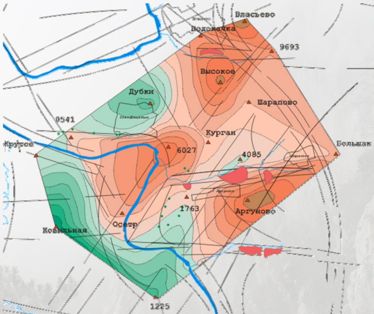
Рис. 9. Схема вертикальных смещений пунктов геодезической сети
