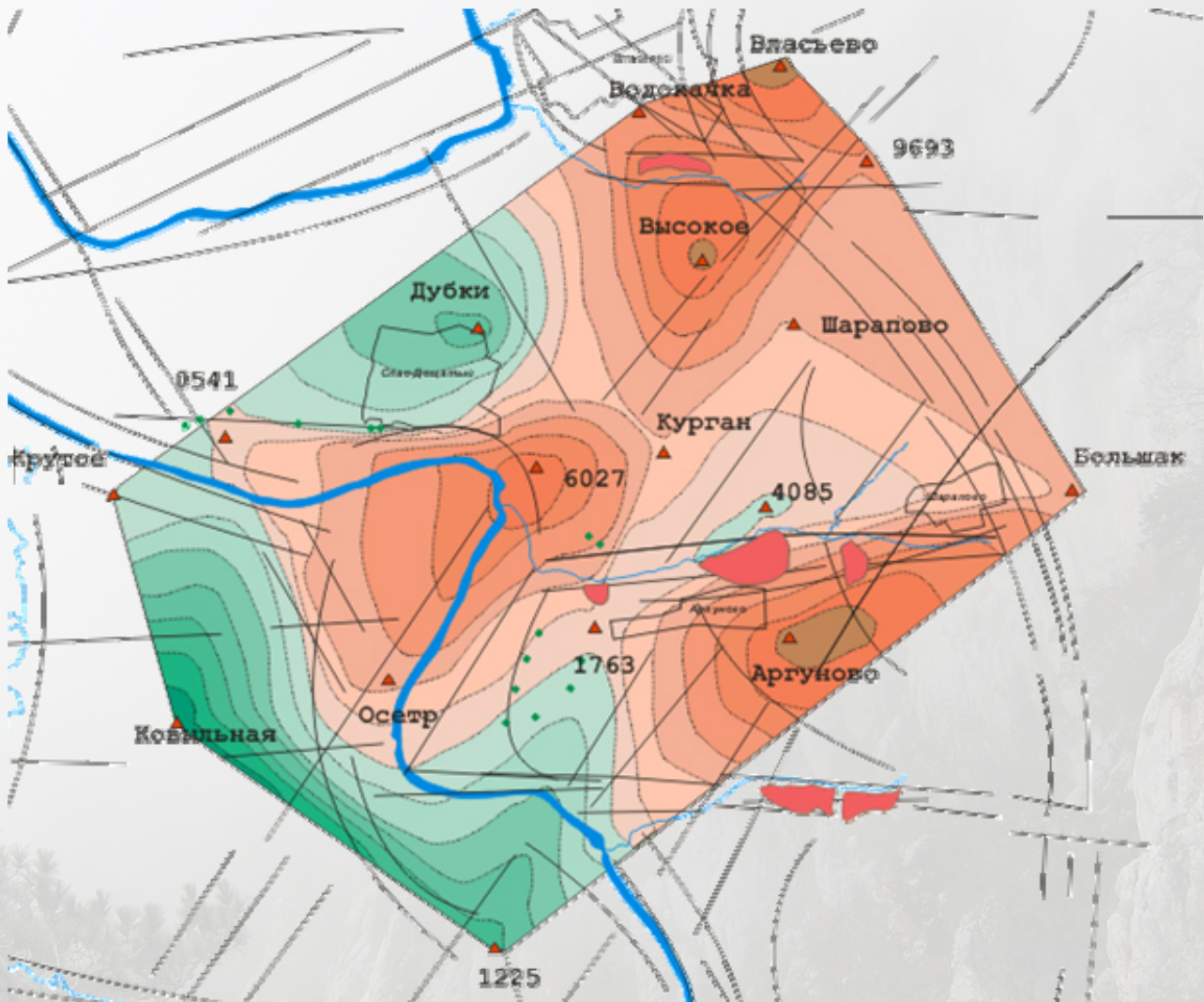
Рис. 9. Схема вертикальных смещений пунктов геодезической сети
